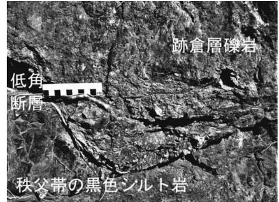
第6-2図 低角断層の拡大写真
