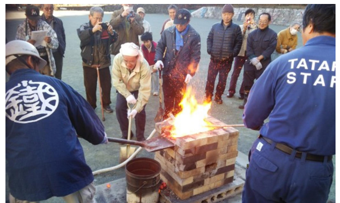
たたら製鉄の実演、ケラ出し 中小坂鉄山研究会、下仁田ジオパークの会、下仁田自然学校による共催普及事業
